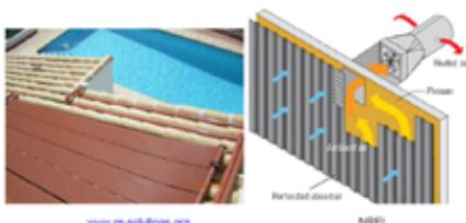
Slika 17.: Niskotemperaturni kolektor za grijanje vode u bazenima i za grijanje prostora
